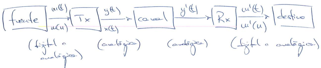
El Tx asume la señal de la fuente (análoga o digital) al canal por el que se va a transmitir.
