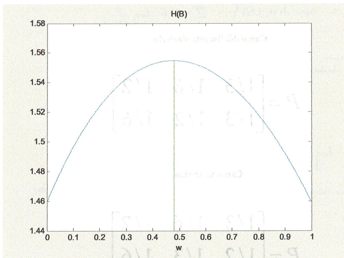
$\text{Max } H(B) = 1.554 \text{ para } w = 0.48$   $\log 3 = 1.584$  ( $p(b_1) = p(b_2) = p(b_3)$ )  $\neq$  símbolos de entrada equiprobables
