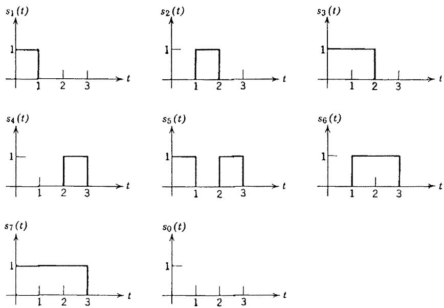
\* 4. Calcula la probabilidad de error mínima para las constelaciones de señales equiprobables de la figura si se transmite la información por un canal AWGN con densidad espectral de ruido de  $N_0/2$  W/Hz.
