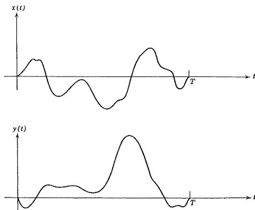
Las señales se emplean para la transmisión de dos mensajes equiprobables por un canal con ruido aditivo, gaussiano y blanco (canal AWGN) cuya densidad espectral de potencia es  $4\text{ W/Hz}$ .
