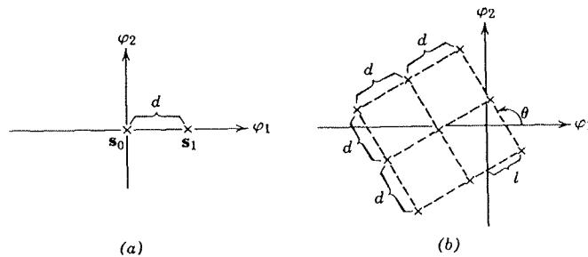
\* 3. Calcula la probabilidad de error mínima que se puede conseguir con las constelaciones de señales equiprobables de la figura si se transmite por un canal AWGN con densidad espectral de ruido de  $N_0/2$  W/Hz.
